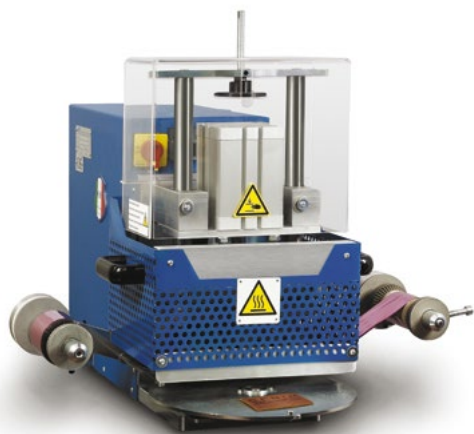
Macchina LEATHER MARKER completa di svolgitore per timbrare utilizzando nastro decorativo (Foil) (Optional)
