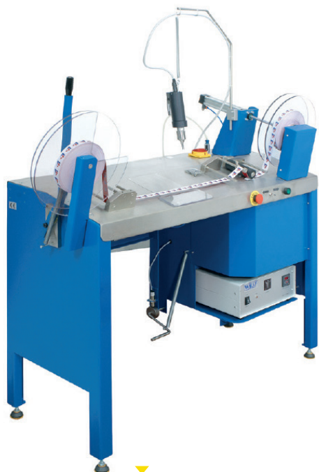
Machine ROLLABEL avec soudeuse à ultrasons (option V)
