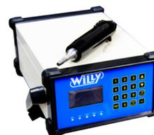
Accessoire permettant d'effectuer des jonctions très résistantes entre le bout final d'un ruban et le bout initial d'un autre ruban.
