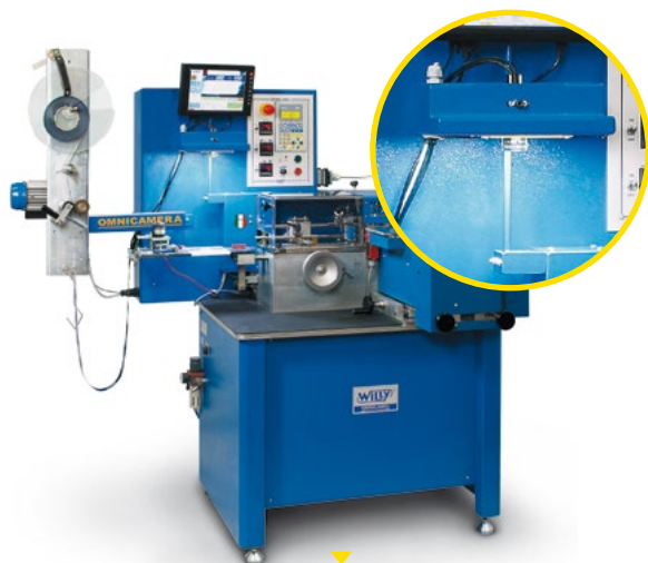
▼ OMNILABEL ELECTRONIC complète avec caméra OMNICAMERA (option) pour le contrôle de qualité de rubans.
