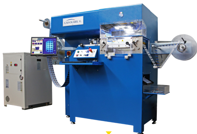
GALVOLABEL XL machine (zone de coupe 230 x 230 mm)
