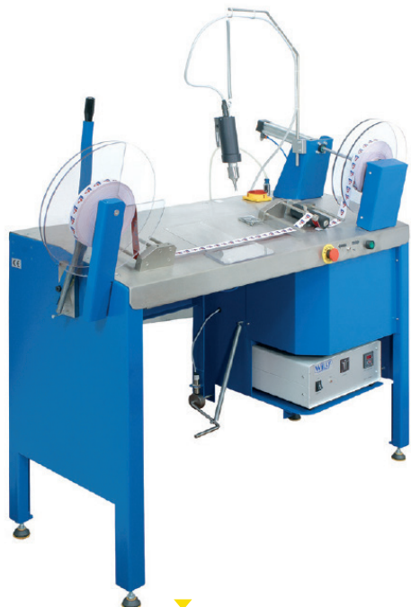
▼ Máquina ROLLABEL equipada con un soldador ultrasónico (opcional V)
