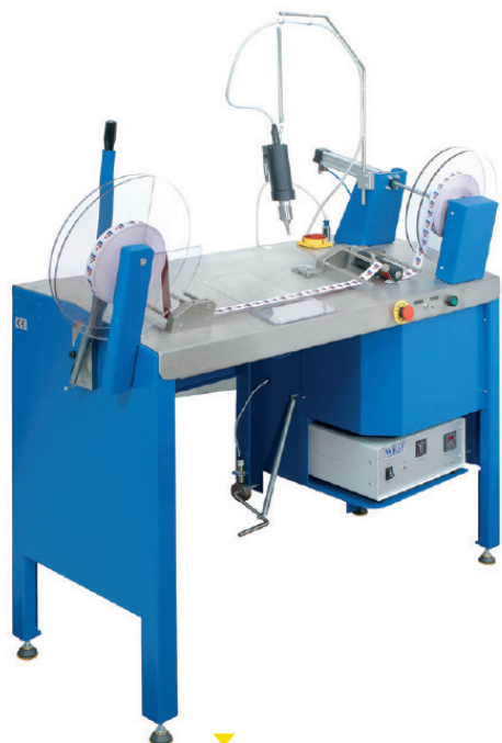
ROLLABEL 设备配有超声波密封单元 (V 选项)
