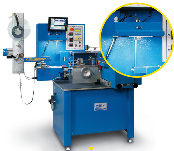
OMNILABEL ELECTRONIC 机型配有 OMNICAMERA (可选), 可用于检查丝带的质量。
