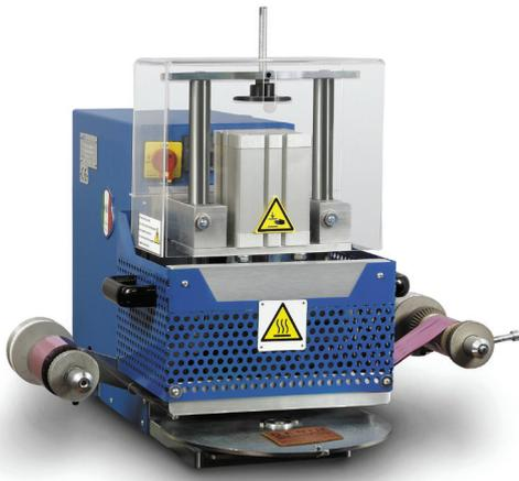
Leather Marker 设备配有放卷机，用于使用装饰带条（箔）（可选）进行烫印
