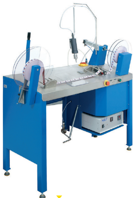
▼ Máquina ROLLABEL com unidade de selagem ultrassónica (opção V)
