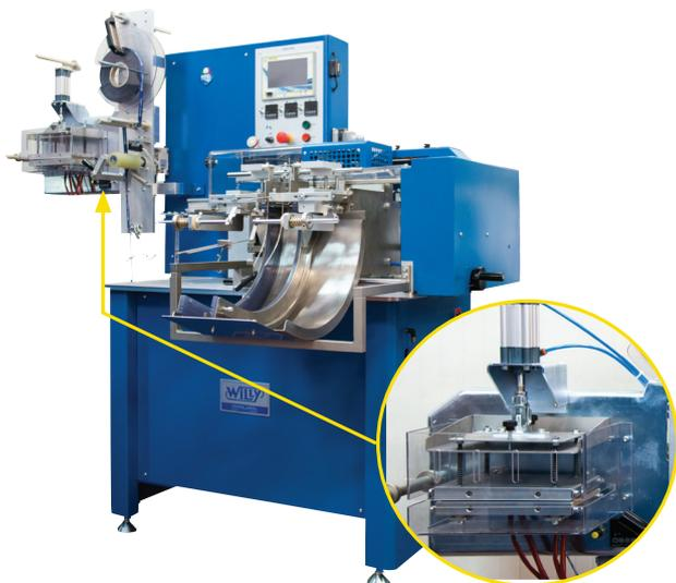
Máquina **OMNILABEL LOGIC 2.0** completa com unidade de engomagem "P" (opção) e unidade de dobragem M100 (opção)
