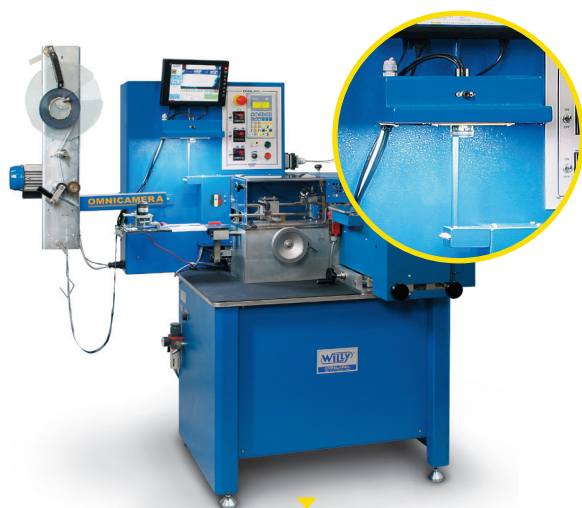
▼ OMNILABEL ELECTRONIC máquina completa com OMNICAMERA (opção) para verificar a qualidade das faixas.
