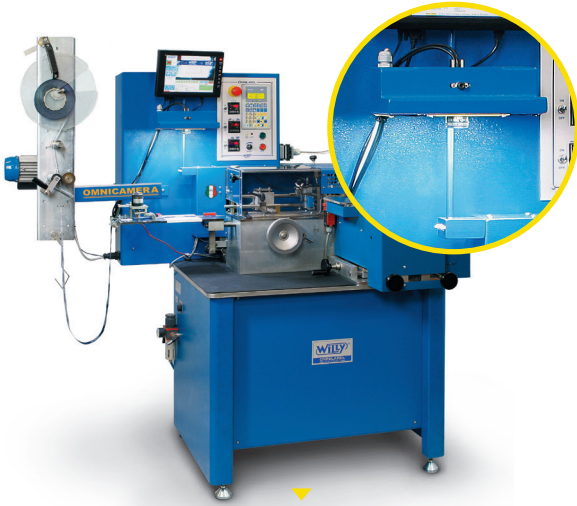
OMNICALCAMERA ELECTRONIC Şeritlerin kalitesini kontrol etmek için OMNICALCAMERA (opsiyonel) ile.
