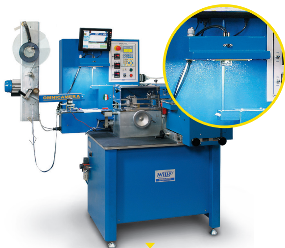
Машина OMNILABEL ELECTRONIC , оснащенная камерой OMNICAMERA (опция) для проверки качества ленты.
