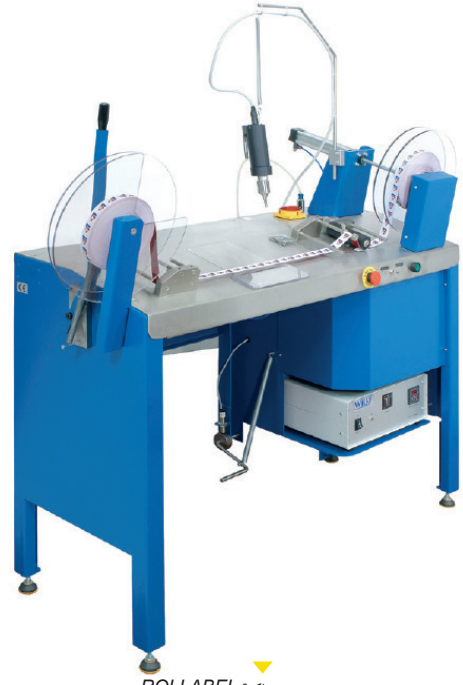
ماكينة ROLLABEL مع وحدة إغلاق بالموجات فوق الصوتية (خيار V)
