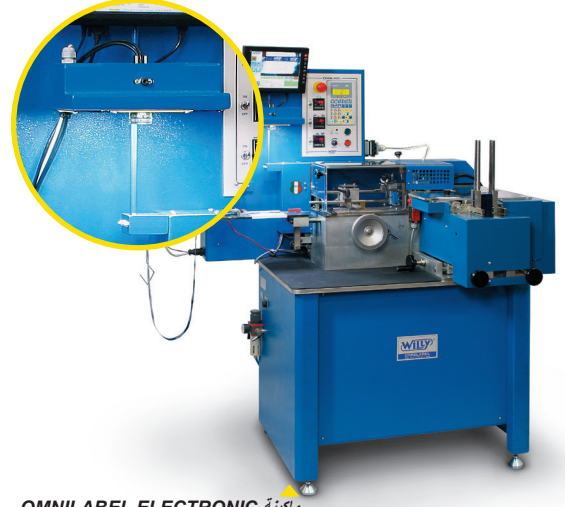
ماكينة OMNILABEL ELECTRONIC متكاملة مع OMNICAMERA (خيار) للتحقق من جودة الأشرطة.
